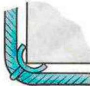
Разрезанные трубы с приварными бобышками
