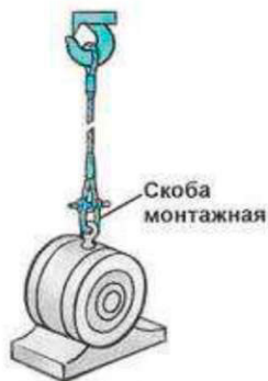
СТРОПОВКА ЭЛЕКТРОДВИГАТЕЛЯ ДВУХПЕТЛЕВЫМ СТРОПОМ
